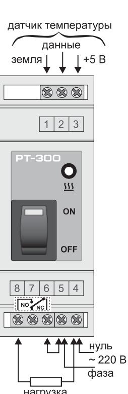
Нагрузка подключается к клеммам 4 и 8. Между клеммами 5 и 6 ставится перемычка. (Клеммы 8 и 6 – выводы нормально разомкнутых контактов реле регулятора, 7 и 6 – нормально замкнутых).
